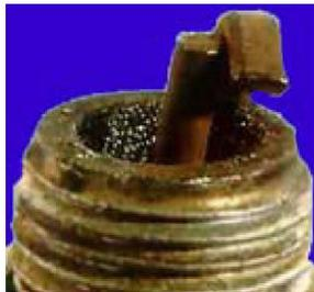
Destrucción mecánica Raro, ¡pero se dice que sucedió! Esta vela fue completamente destruida por contacto con objetos en la cámara de combustión. Las razones deben ser investigadas. Tal vez las válvulas o el pistón estén rotos o se hayan desprendido grandes depósitos de carbón. Quizás se instaló una bujía que era demasiado larga y entró en contacto con las válvulas o el pistón. Por lo tanto, verifique todos los puntos e instale velas nuevas de acuerdo con la tabla de comparación.
