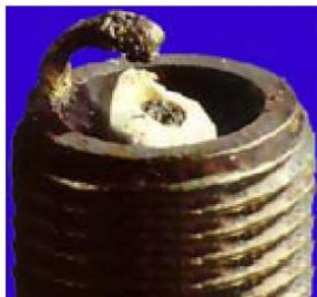
Electrodos y aislante derretidos Si ignora el golpeteo del motor durante un largo período de tiempo, los electrodos e incluso el aislante se derretirán literalmente. Un valor de calor incorrecto, una configuración pobre del carburador, aire secundario o un preencendido extremo podrían haber sido el desencadenante.
