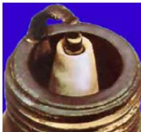
**Sobrecalentamiento** En este caso, puede ver que el aislante está blanco como la tiza y no han aparecido depósitos. El cuerpo de metal puede incluso haberse vuelto azulado. ¡El motor se calentó demasiado! La causa podría ser un valor calorífico demasiado bajo de la bujía, un punto de encendido ajustado (anticipado) o una mezcla de combustible y aire demasiado pobre. Por lo tanto, verifique todos los puntos y monte velas nuevas de acuerdo con la tabla de comparación.
