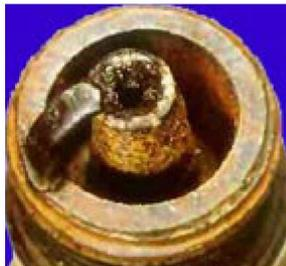
Electrodo central/de tierra derretido debido a un ruido metálico del motor Si el electrodo central y/o de tierra se ha derretido, en este punto se han producido una ignición por incandescencia descontrolada y altas temperaturas. Un valor de calor incorrecto, válvulas sobrecalentadas, ajuste pobre del carburador o aire secundario podrían haber sido la causa.
