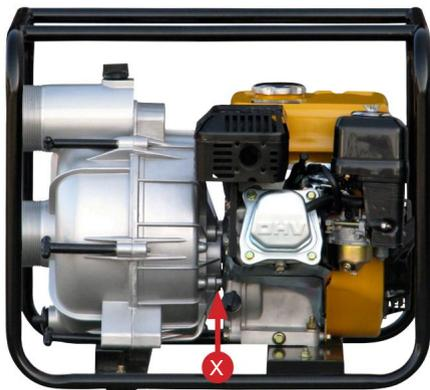
Puede reconocer un anillo de sellado del eje defectuoso por el hecho de que en el eje del motor en el punto (X) el agua se escapa.
