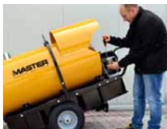
BV 500 kan tiltes for let adgang til brænderen og det elektroniske kontrol panel
