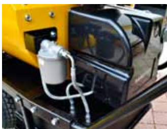
Varmekanonen fungerer med brændstoftank, men kan også tilsluttes til en ekstern brændstoftank
