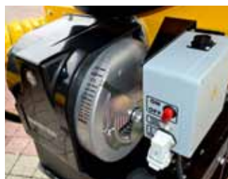
Kontrol panel inklusiv: on/off knap med lys indikator, resetknap, udtag for rumtermostat: analog eller digital
