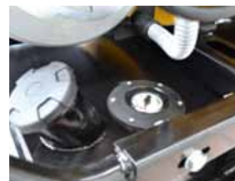
En leakless brændstoftank, og en stor brændstofs niveau indikator
