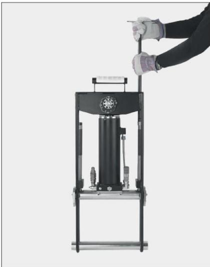
Llave en "T" larga para el bloqueo mecánico de seguridad de la tubería en compresión total
