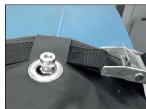
Detalle del sistema de instalación rápida de las mangueras en la boca de la herramienta
