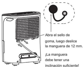
Para que el deshumidificador funcione sin supervisión durante más tiempo sin que se apague por tener el depósito de agua lleno, existe la opción de instalar una manguera de desagüe directa. Proceda de la siguiente manera: • Retire el tapón de sellado en la parte posterior de la
