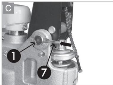
Impulse el pasador del eje completamente a través de ambos montajes con un martillo. Asegúrese de que la chaveta derecha esté en el hueco (vea la figura B).
