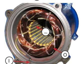
Puede ver el devanado del estator (O) del motor y el cable del sensor de aceite (I) en esta ilustración. Revise el estator en busca de signos de desgaste en el interior (P); esto indicaría un rodamiento defectuoso.
