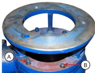
• Retire los 3 tornillos (A) - no los tornillos (B). Separe el soporte.
