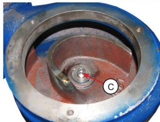
• Abra el tornillo (C) - esta es la conexión del tornillo del impulsor.
